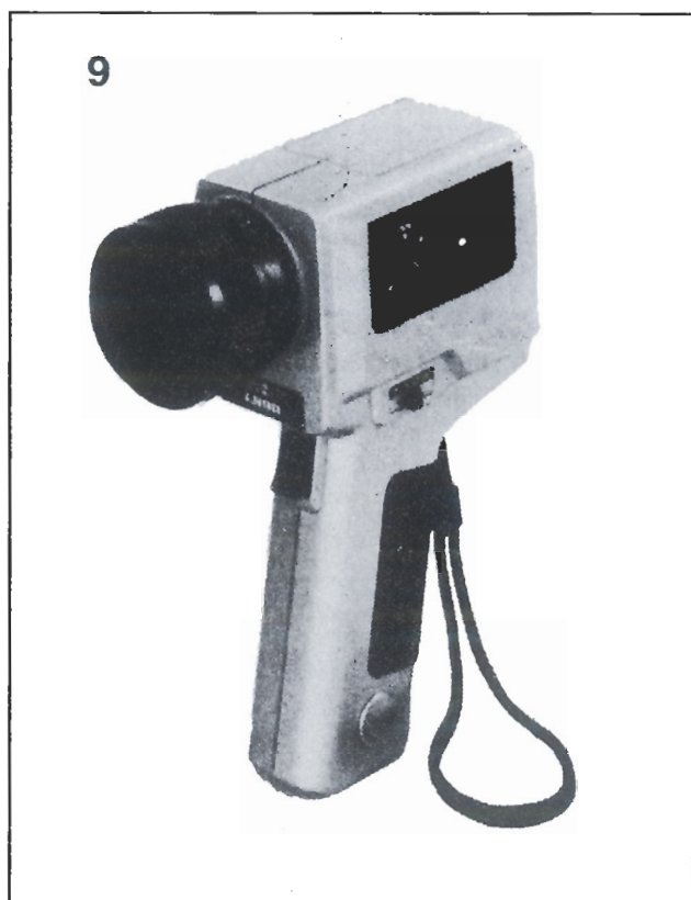
Figura 9. Este dispositivo de mano mide temperaturas usando el sistema de termometría de radiación infrarroja sin contacto.
